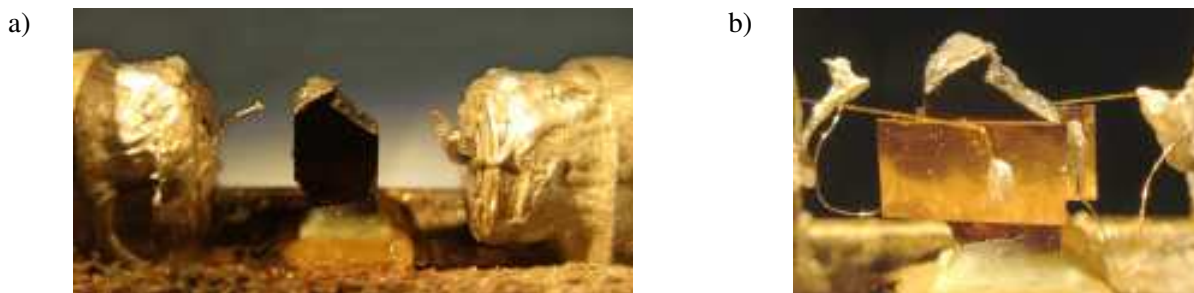
Рис. 3.2. а) Образец, установленный на держателе образца. б) Образец с приклеенными ультразвуковыми преобразователями
