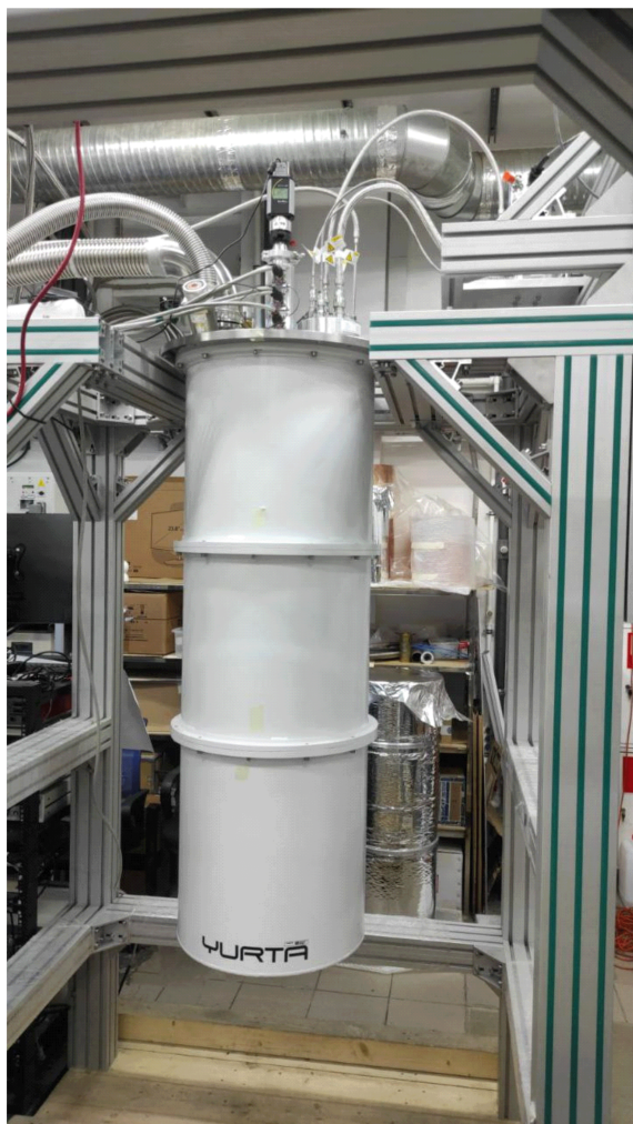
Рис. 1. Рефрижератор растворения ^3\text{He} в ^4\text{He} высокой холодопроизводительности.
