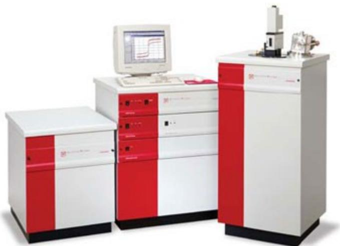
Фотография системы MPMS в опции с криостатом замкнутого цикла. Слева-направо: стойка компрессора, стойка электроники, стойка с криостатом. С сайта фирмы Quantum Design <http://www.qdusa.com/products/mpms.html>.
