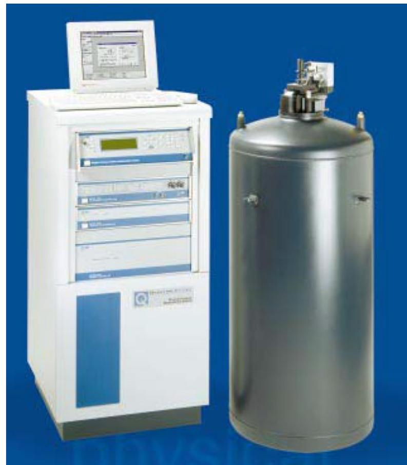
Фотография системы PPMS. Слева - стойка электроники, справа - дьюар. Из брошюры PPMS: Physical Property Measurement System
