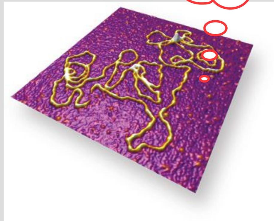
Изображение молекулы ДНК, полученное атомным силовым микроскопом. Размер области сканирования 530 нм. С сайта Intertech Corporation, AFM Images, 2012, [www.intertech-corp.ru](http://www.intertech-corp.ru)
